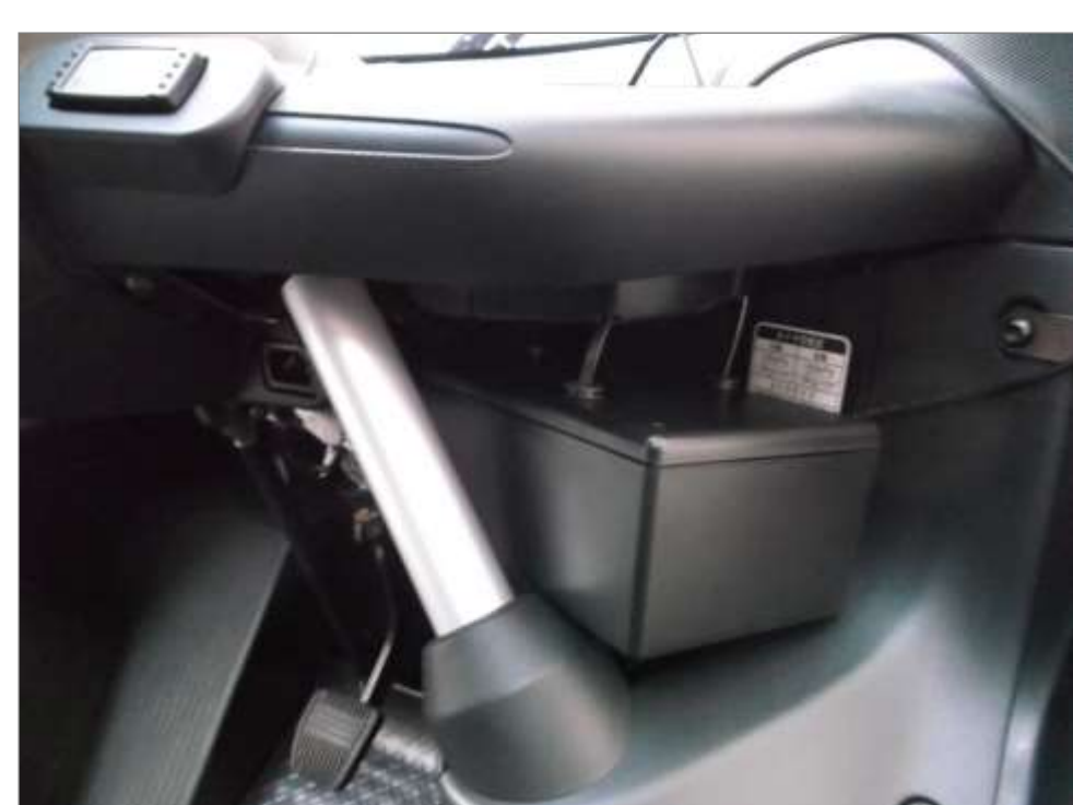
図6 車載計測器の設置状況
